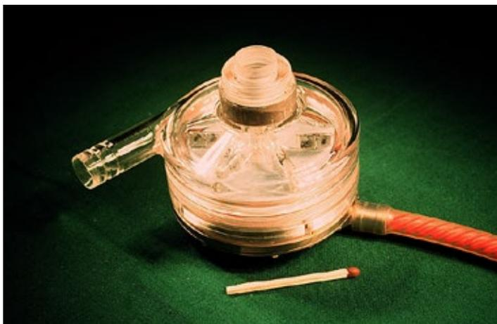
Wiener Implantierbare Zentrifugalpumpe 1995
